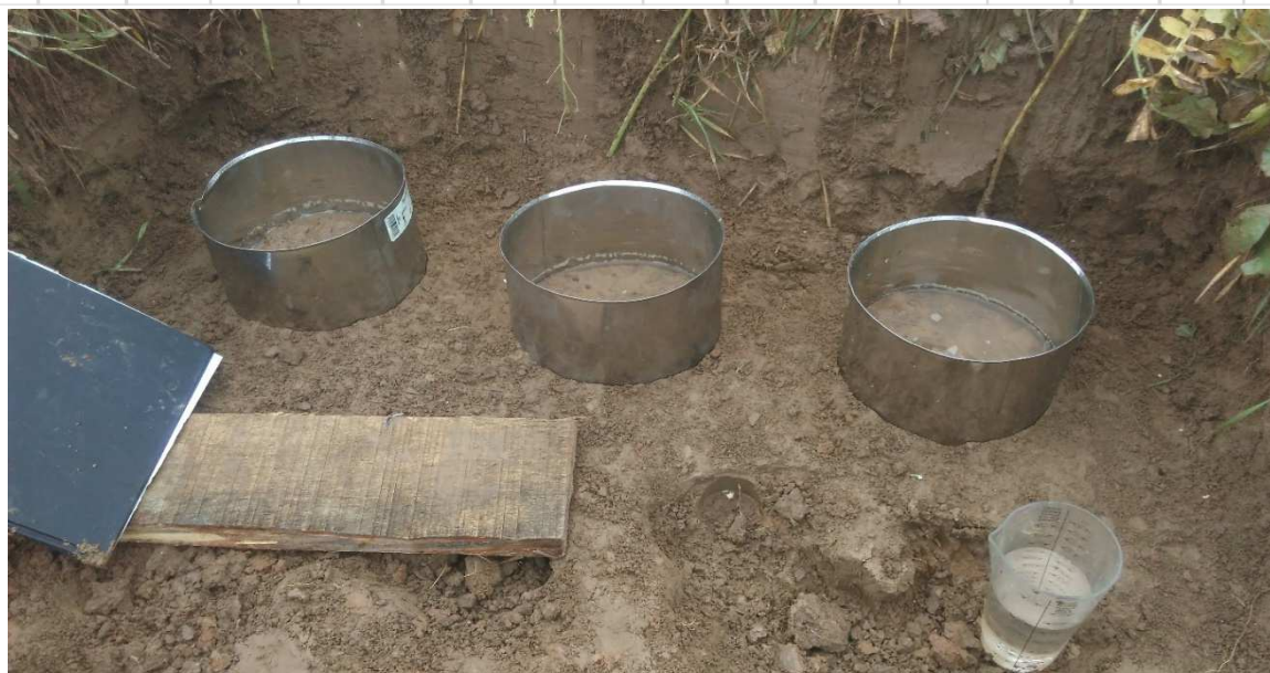
Figure 1 : Tests d'infiltration "beer can" réalisé sur l'essai d'Attichy
